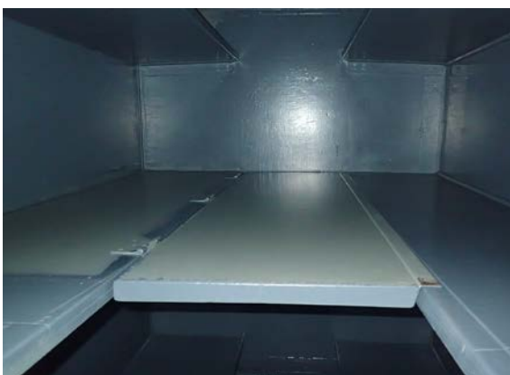
А Большая камера в тюремном вагоне с разложенной маленькой полкой между двумя средними полками.
