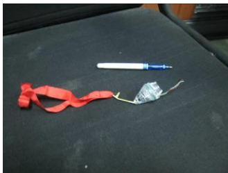
Dispositif de sécurité / d'armement de la bombe à sous-munitions MAT-120.
