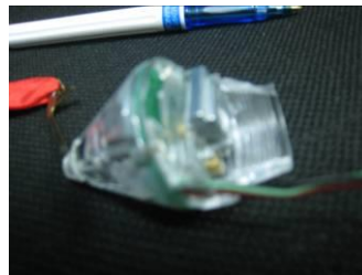
Dispositif de sécurité / d'armement de la bombe à sous-munitions MAT-120.
